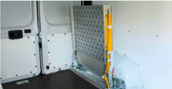
Geanodiseerd aluminium geperforeerd rijvlak
