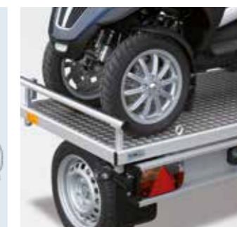
Set di allestimento per scooter con binario di salita in 3 parti
