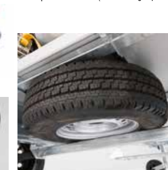
Portaruota di scorta per la motrice (tenere conto della misura del pneumatico)
