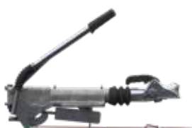
Leva freno a mano chiusa (freno di stazionamento in senso di marcia)
