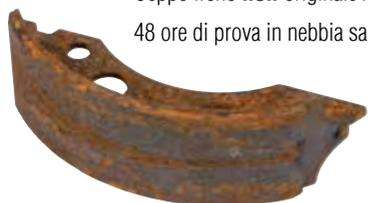
Ceppo freno originale AL-KO dopo 48 ore di prova in nebbia salina
