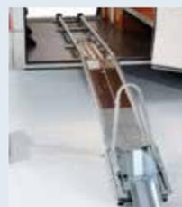
Schienensystem mit Vorderradschlitten
