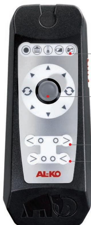
Control-Panel mit Anzeige von Batterie (Wohnwagen / Fernbedienung) und Überlast
