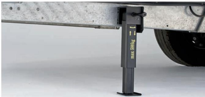
Stütze fährt automatisch teleskopartig aus.
