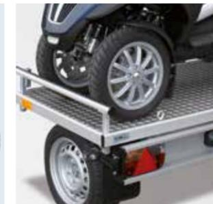
Rüstsatz Dreiradroller mit 3-teiliger Auffahrschiene
