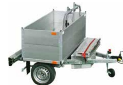
Aluminium Bordwände 600 mm Höhe auf WHEELY
