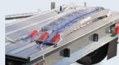
Klappbare Auffahrrampe. Bis 340 kg belastbar.
