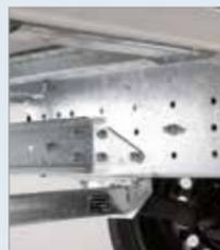
Modulare Rahmenanbindung um die Deichsellängen bis zu 300 mm verlängern zu können. Eine Achsverschiebung ist je nach Ladung möglich.
